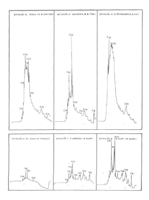
FIGURA 5. Cromatogramas de las n- Parofinas Obtenidas en Sedimentos del Pacífico Colombiano.
