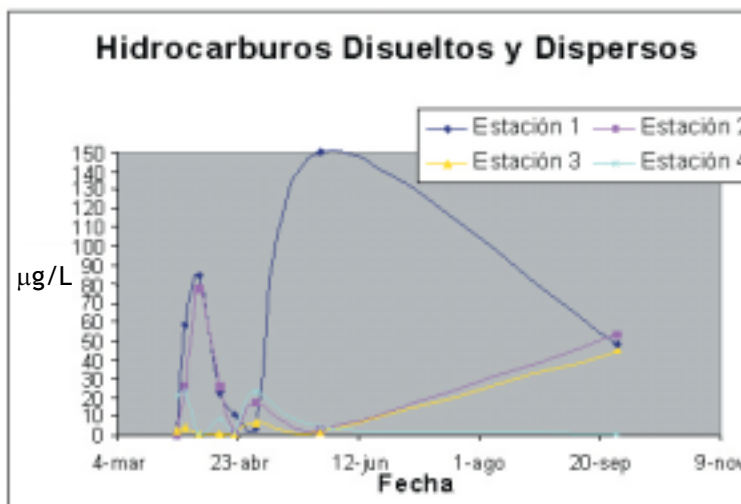
Figura 7. Comportamiento de HDD's durante el monitoreo en el área de estudio.
