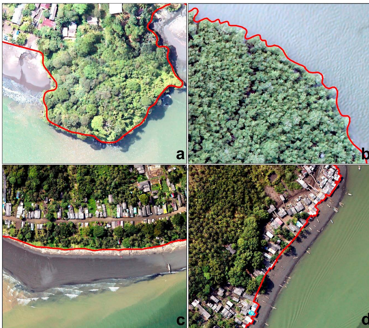
Figura 2. Criterios para digitalización de las líneas de costa. a. Línea de costa definida por la base de los acantilados. b. Línea de costa definida por el borde de manglares en planos intermareales. c. Línea de costa definida por el límite interno de una playa. d. Línea de costa definida por el borde de las infraestructuras.
