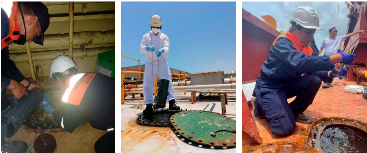
Figura 2. Muestreo microbiológico de agua de lastre a bordo de buques.
